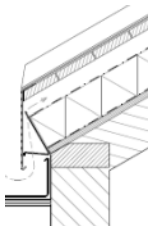
afb. 37 b voet / goot aansluiting
