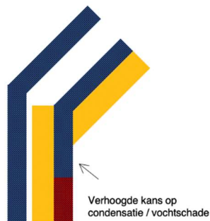
Afbeelding 2114-03-2 Isolatie aan buitenzijde gevel en aan binnenzijde dak
