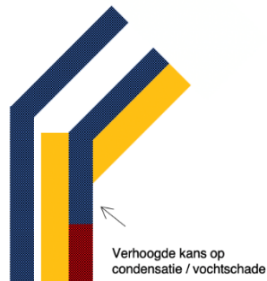
Afbeelding 2114-02-2 Isolatie aan buitenzijde gevel en aan binnenzijde dak
